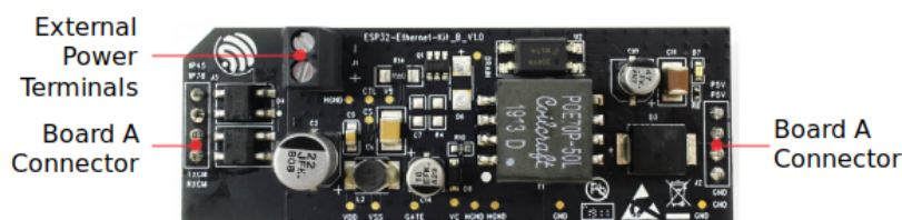
图 19: ESP32-Ethernet-Kit - PoE 子板 (B 板) 布局 (点击放大)
